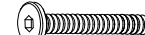
6 x4 Allen bolt M6*40mm * x4 Vis à tête creuse hexagonale M6*40mm x4 Perno Allen M6*40mm
