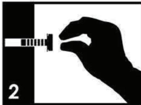
2 Positionnez correctement chacune des pièces et insérez les vis dans leurs orifices respectifs. Puis serrez à la main seulement jusqu'à 70 %. Resserment complète avec les outils viendra à une étape ultérieure.
