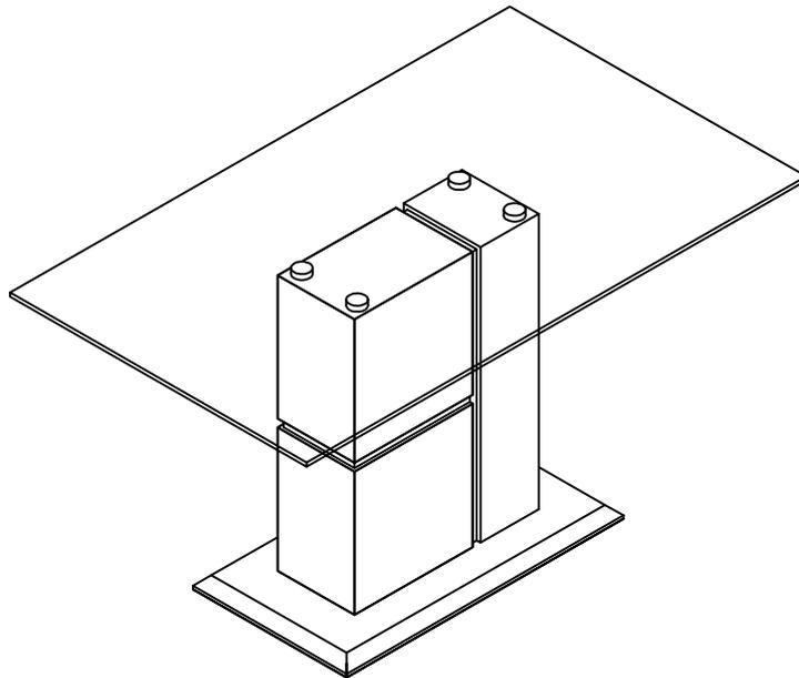
Maximum weight bearing capacity / Poids maximum de capacité roulement : 275lbs / 125 kgs
