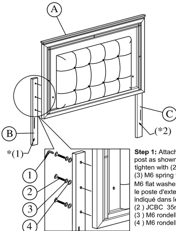
**Step 1:** Attach the (B) extension post as shown in the drawing and tighten with (2) JCBC 35mm, (3) M6 spring washer & (4) M6 flat washer. / Étape 1: Attachez le poste d'extension (B) comme indiqué dans le dessin et serrez avec (2) JCBC 35mm des boulons, (3) M6 rondelle d'arrêt et (4) M6 rondelle plate.
